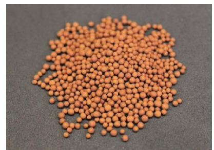
Der für den Sorptionsreaktor benötigte Eisenkatalysator nach der Synthese
