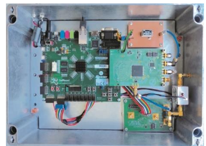
GNSS Empfänger Hardware
